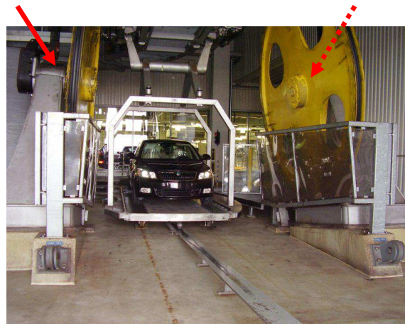
OBR. 2: VYSOKÁ ZÁTĚŽ MONITOROVANÝCH LOŽISEK, HMOTNOST VOZU VW TOUAREG JE PŘES 2000 KG.
