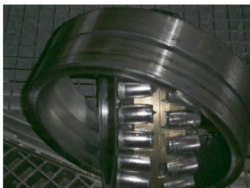
OBR. 4: SKUTEČNÝ STAV LOŽISKA PO NAMĚŘENÍ POŠKOZENÍ. PROSTŘEDNÍ OBRÁZEK - PRASKLÝ VALIVÝ ELEMENT, KRAJNÍ OBRÁZKY – ÚNAVOVÉ POŠKOZENÍ POVRCHU.
