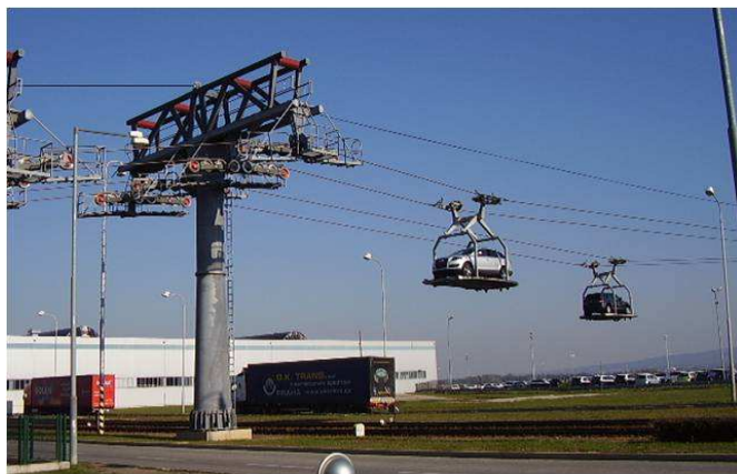
OBR. 1: LANOVKA VW BRATISLAVA. VÝROBCE DOPPELMAJR, HORIZONTÁLNÍ DÉLKA 452M, MAX. RYCHLOST 2,8 M/S, MAX. KAPACITA 502 VOZŮ ZA SMĚNU.
